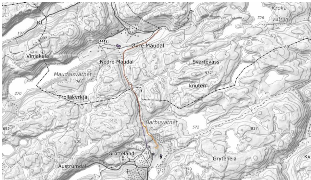
Figur 2.2. Tiltaket omfatter naturområdet mellom Maudal og Stavtjørn. Eksisterende trasé vil saneres, fjernes og føres opp med nye master og kraftlinje (brun linje). Nært Stavtjørn (rundt skriften Barbuvatnet) vil ny linje legges i jordkabel som følger traktorvei (oransje linje). Eksisterende linje vil saneres og fjernes (lilla linje). I forbindelse med anleggsarbeidet behøves areal til hjelpeanlegg med fire foreslåtte plasseringer (lilla polygoner).
